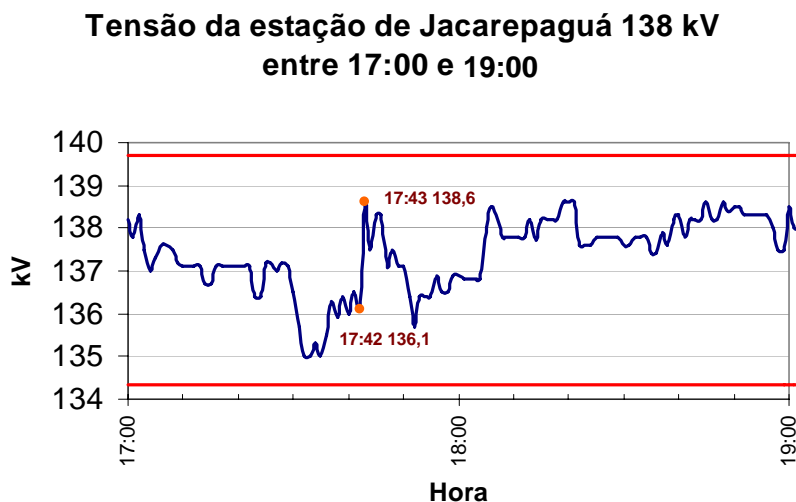
Figura 12 – Correção da tensão no período de carga pesada
