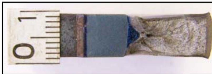
Figura 3.12- Foto do corpo de prova faturado.
