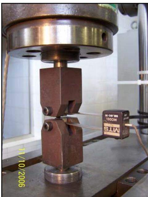
Figura 3.9- Extensômetro de fratura.
