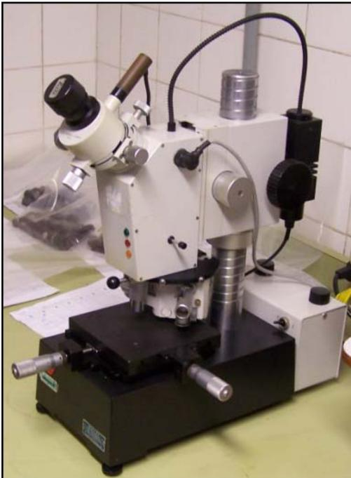
Figura 3.13- Microdurômetro Shimadzu-2000.
