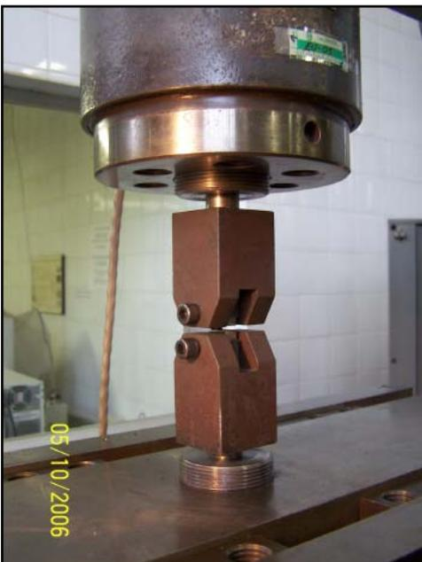
Figura 3.8- Pré-trincamento do corpo de prova.
