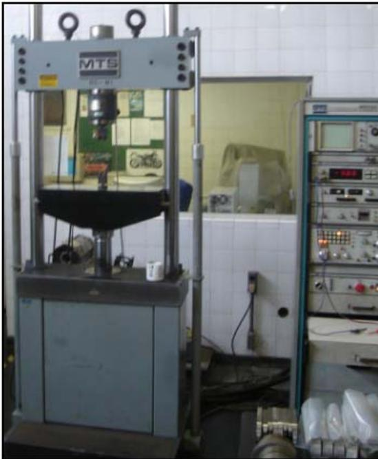
Figura 3.7- Máquina servo-hidráulica MTS.
