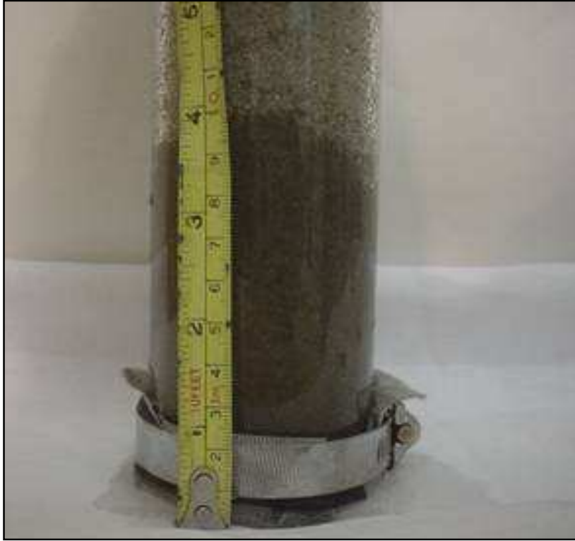
Figura 4.7- Camada de material na base com maior saturação.
