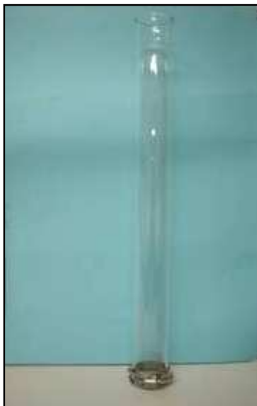
Figura 4.6- Apresentação da coluna de ensaio e da malha colocada na base para sustentar o material.
