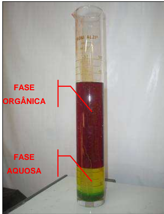
Figura 4.12- Efluente dos ensaios de gasolina com etanol sem corante apresentando duas fases.
