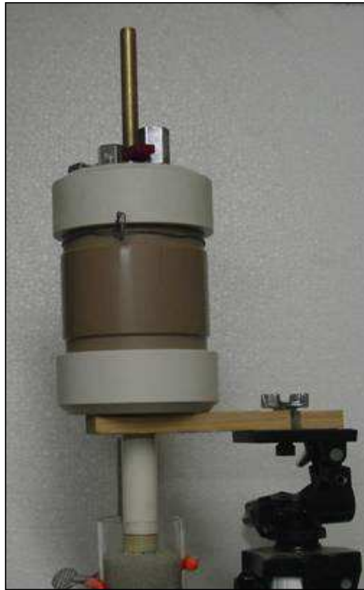
Figura 4.9- Permeâmetro desenvolvido na PUC-Rio para aplicação de carga constante de contaminante.
