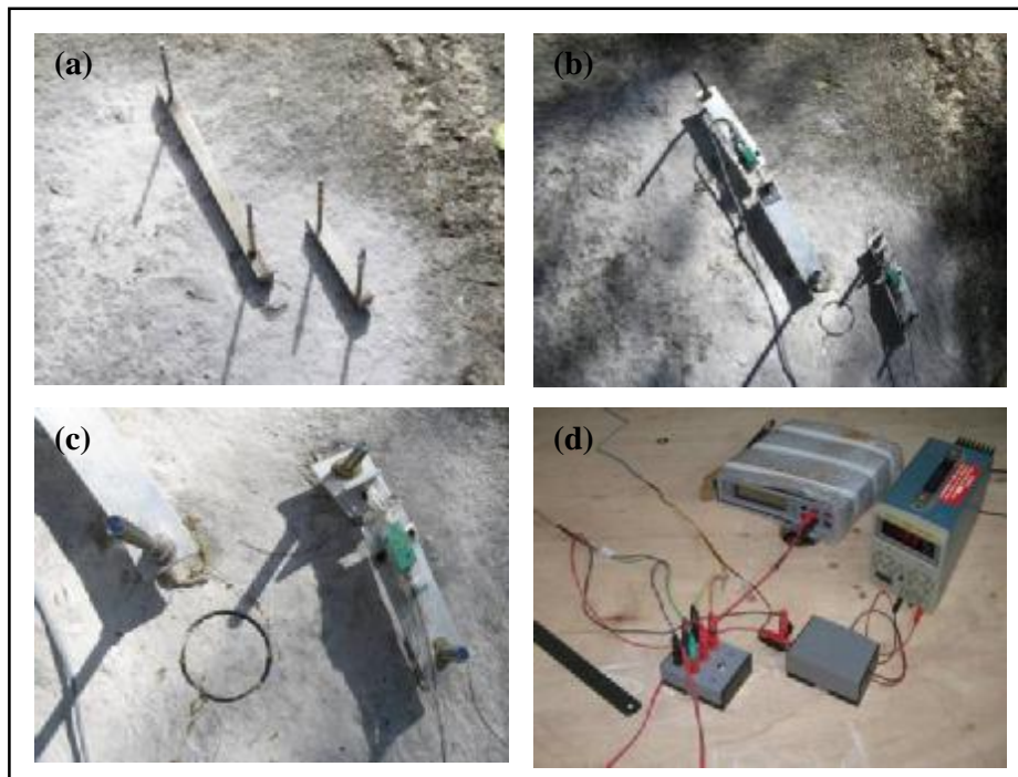
Figura 7.12 – (a) Momento de secagem do cimentante químico, (b) disposição dos LVDT's ao redor do furo IPP-2, (c) detalhe do LVDT protegido com filme de PVC transparente, (d) instrumentação para medição dos deslocamentos.
