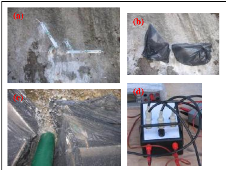
Figura 7.14 – (a) Disposição dos LVDTs no furo IPP-3, (b) protetores plásticos cobrindo todo o sistema de monitoramento dos deslocamentos, (c) momento da perfuração, detalhe da água espirrando sobre os protetores plásticos, (d) caixa seletora usada neste ensaio.
