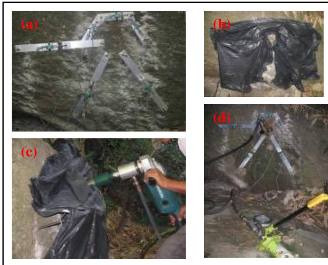
Figura 7.21 – (a) Disposição dos LVDT's no furo PUC-3, (b) protetores plásticos cobrindo todo o sistema de monitoramento dos deslocamentos, (c) Perfuração do furo central, (d) estágio de pressurização.
