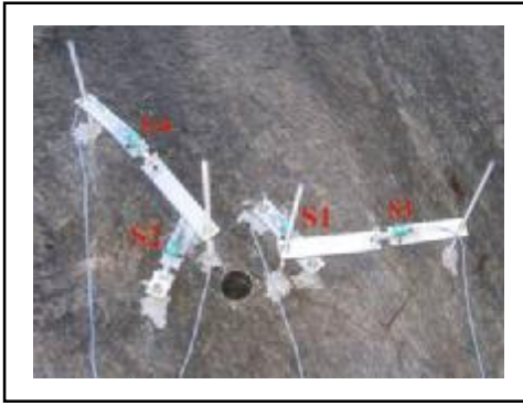
Figura 7.24 – Disposição dos LVDT's no furo IPP-3.
