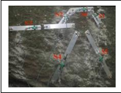
Figura 7.26 – Disposição dos LVDT's no furo PUC-3.
