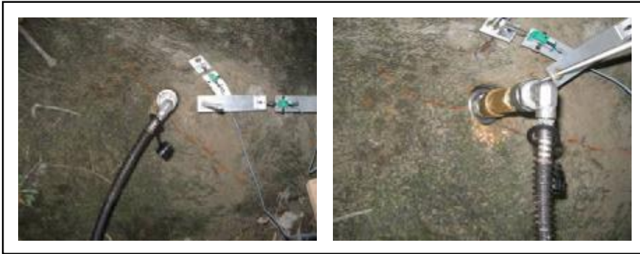
Figura 7.4 – Trinca gerada na rocha como produto da pressurização do furo.
