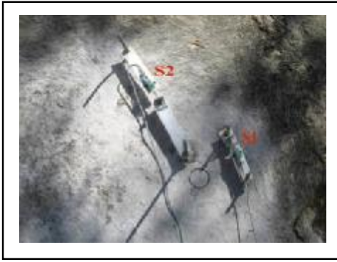
Figura 7.22 – Disposição dos LVDTs no furo IPP-2.
