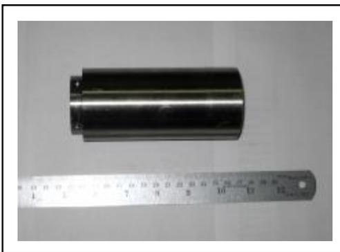
Figura 5.3 – Camisa protetora do pressômetro.
