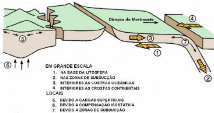
Figura 3.11 – Origem e orientação das tensões tectônicas segundo Zoback et al. (1989), extraído de Amadei (1997).
