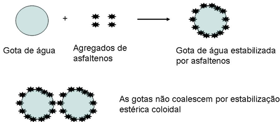
Figura 2.4: Estabilização de emulsões de gotas de água pela ação de partículas de asfaltenos na superfície da gota.
