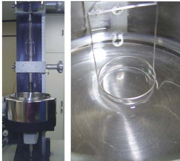
Figura 2.14: Tensiômetro de anel.
