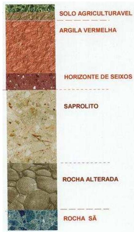
Figura 5 – Perfil Típico de Solo na Região da Barragem de Itaipu
