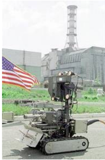
Figura 3 - Robô Pioneer [6], projetado para fazer exploração em áreas radioativas.
