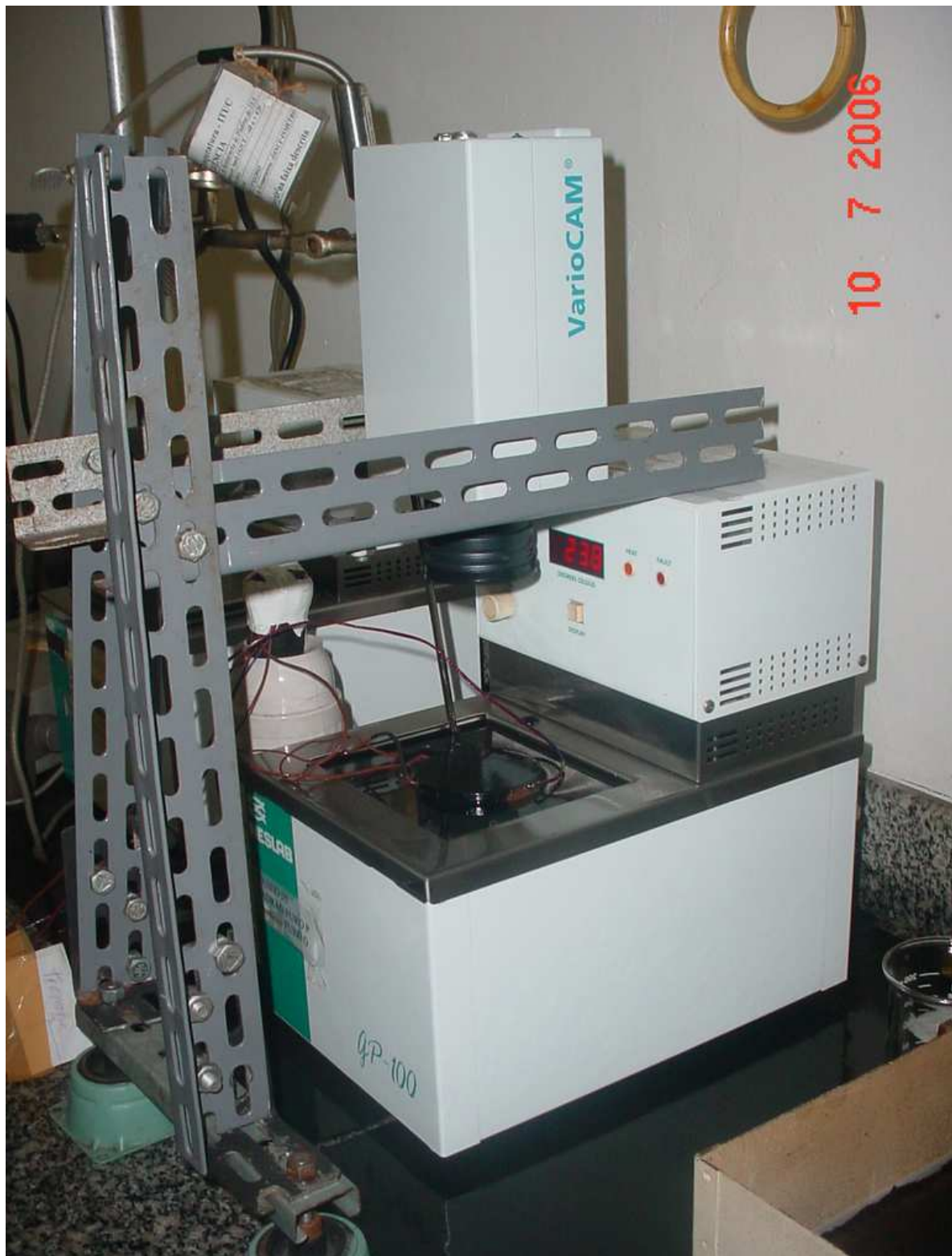
Figura 24: Montagem do dispositivo para calibração do termovisor.
