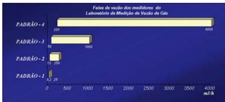
Figura 4: Faixa de medição dos padrões usados na bancada de alta vazão
