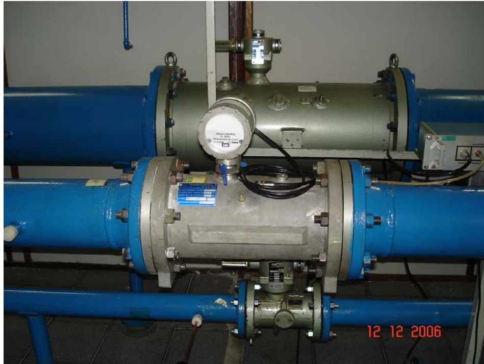
Figura 9: Padrões de trabalho da Bancada de Calibração de Turbinas
