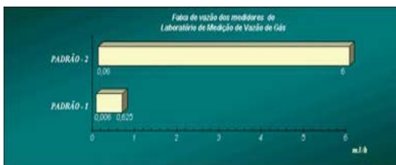
Figura 6: Faixa de medição dos padrões usados na bancada de baixa vazão.
