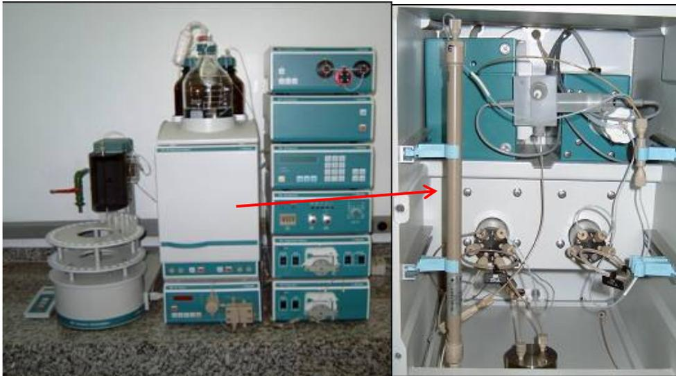
Figura 9 : Diversos módulos que compõem o cromatógrafo de íons (à esquerda) e o centro de separação em detalhes (coluna de separação, *loop* de injeção, etc.).
