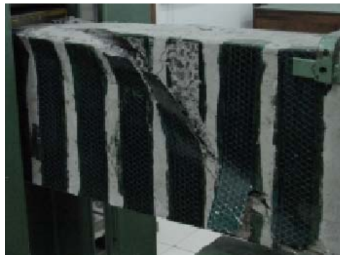
Figura 2.7 – Foto de um viga de concreto armado reforçada com CFRP colado apenas nas laterais da viga, em faixas e com \beta = 90^\circ , após a ruptura, devido ao descolamento do reforço; retirada de Beber (2003).
