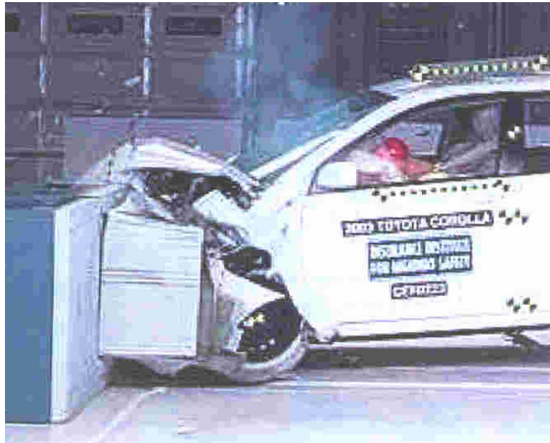
Figura 2.5 Fotografia de um veículo submetido a cargas dinâmicas em um ensaio de impacto [11].
