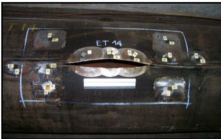
Figura 5-1 – ET 14 após o teste de pressão com as marcações para o corte.
