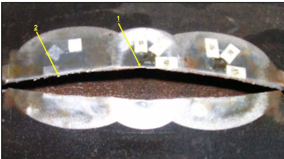
Figura 5-16 – Análise macroscópica da falha do ET 14 mostrando detalhe do início da fratura e do rasgamento dútil
