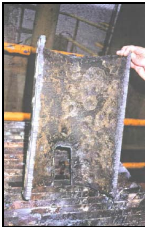
Figura 2-1 – Aspecto da corrosão induzida por microrganismos na presença de incrustação de sulfato de bário e estrôncio ( \text{BaSO}_4 , \text{SrSO}_4 )
