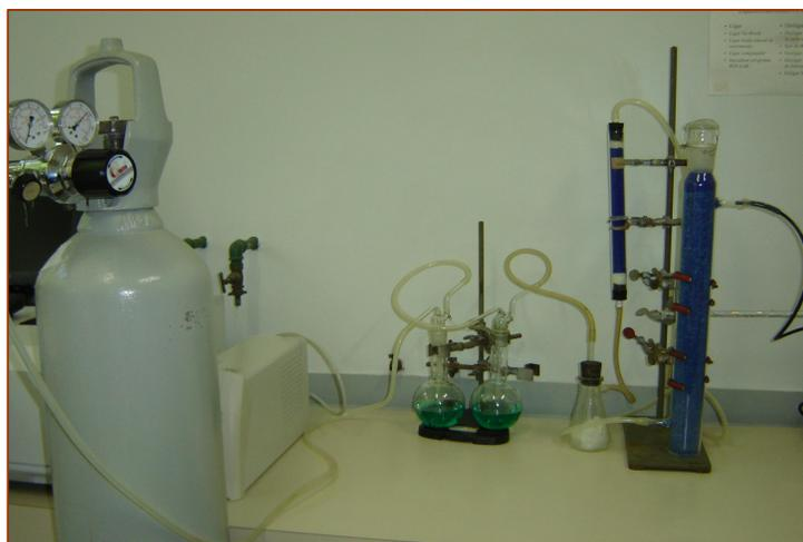
Figura 3.1. Sistema de desoxigenação e secagem do nitrogênio.
