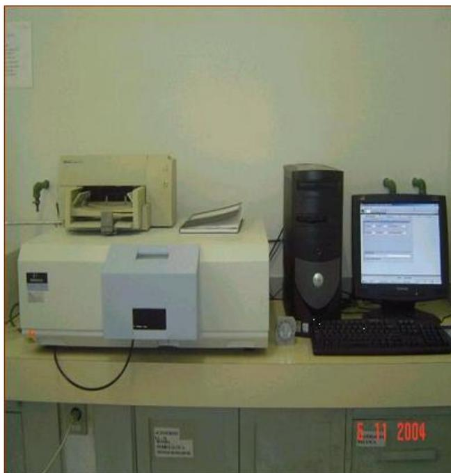
Figura 3.2. Espectrômetro de luminescência Perkin-Elmer – modelo LS 55.
