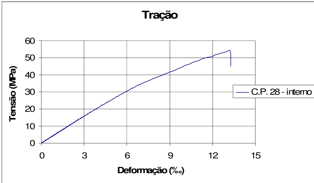
Figura A.II. 24 - Curva tensão de tração-deformação do corpo de prova 28 - fatia interna da região basal do bambu Guadua weberbaueri .
