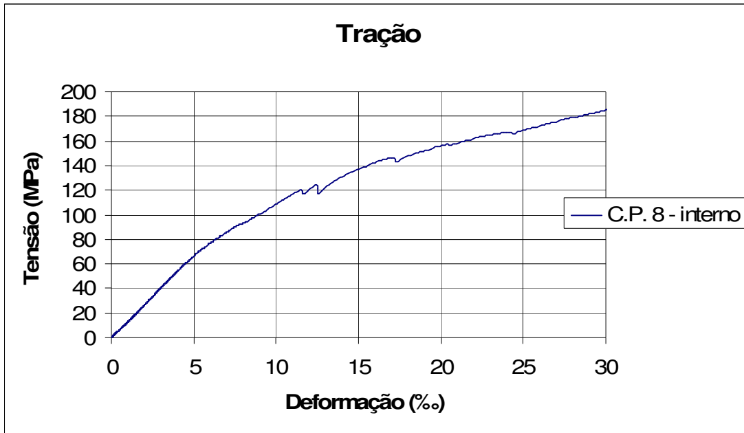
Figura A.II. 8 - Curva tensão de tração-deformação do corpo de prova 8 - fatia interna da região basal do bambu Guadua weberbaueri .
