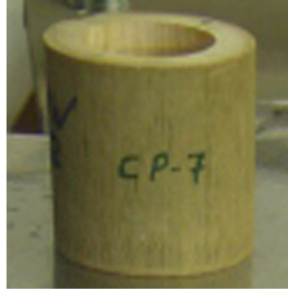
Figura 3.1 - Corpo de prova para os ensaios de peso específico e teor de umidade natural.
