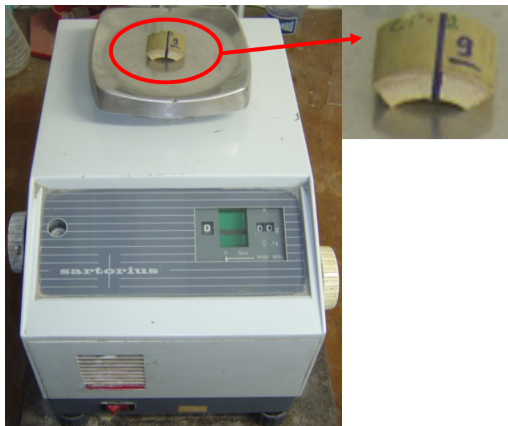
Figura 3.2 - Pesagem do corpo de prova do ensaio de absorção de água.
