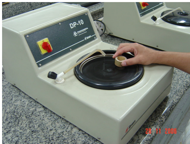
Figura 3.4 - Lixamento e polimento da amostra.
