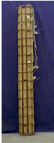
Figura 2.1 - Armadura longitudinal de pilar em bambu. Fonte: Rosa (2002).
