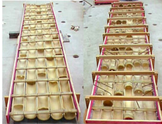
Figura 2.2 - Fôrmas permanentes de lajes armadas com bambu. Fonte: Achá (2002).
