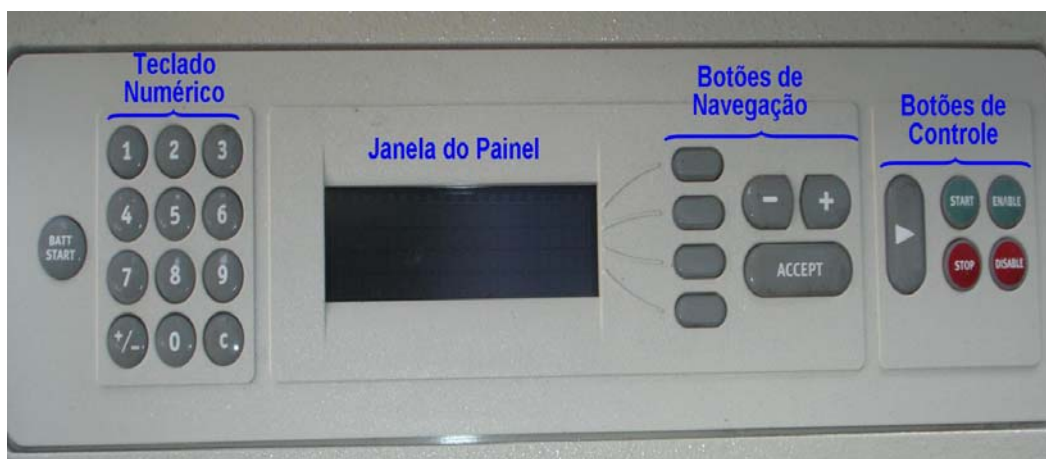
Figura 22 - Painel de controle da microturbina Capstone C30 LPNG.
