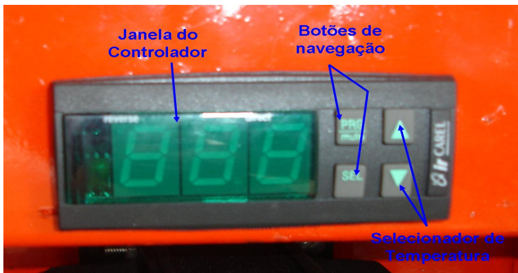
Figura 30 - Painel do Controlador de Temperatura.
