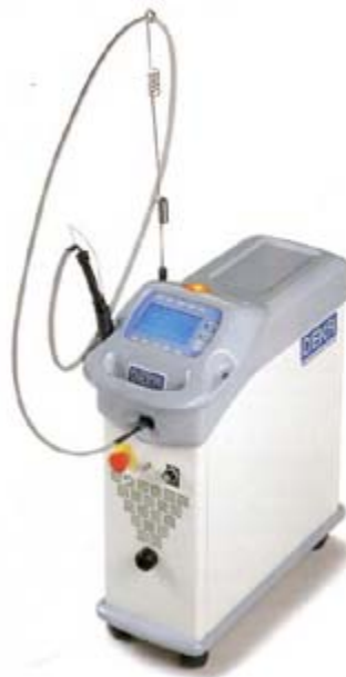
Figura 15 – Equipamento a laser Nd:YAG utilizado em dermatologia e angiologia [64].
