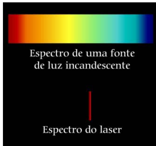
Figura 4 – Espectro luminoso do IPL e do laser [10]
