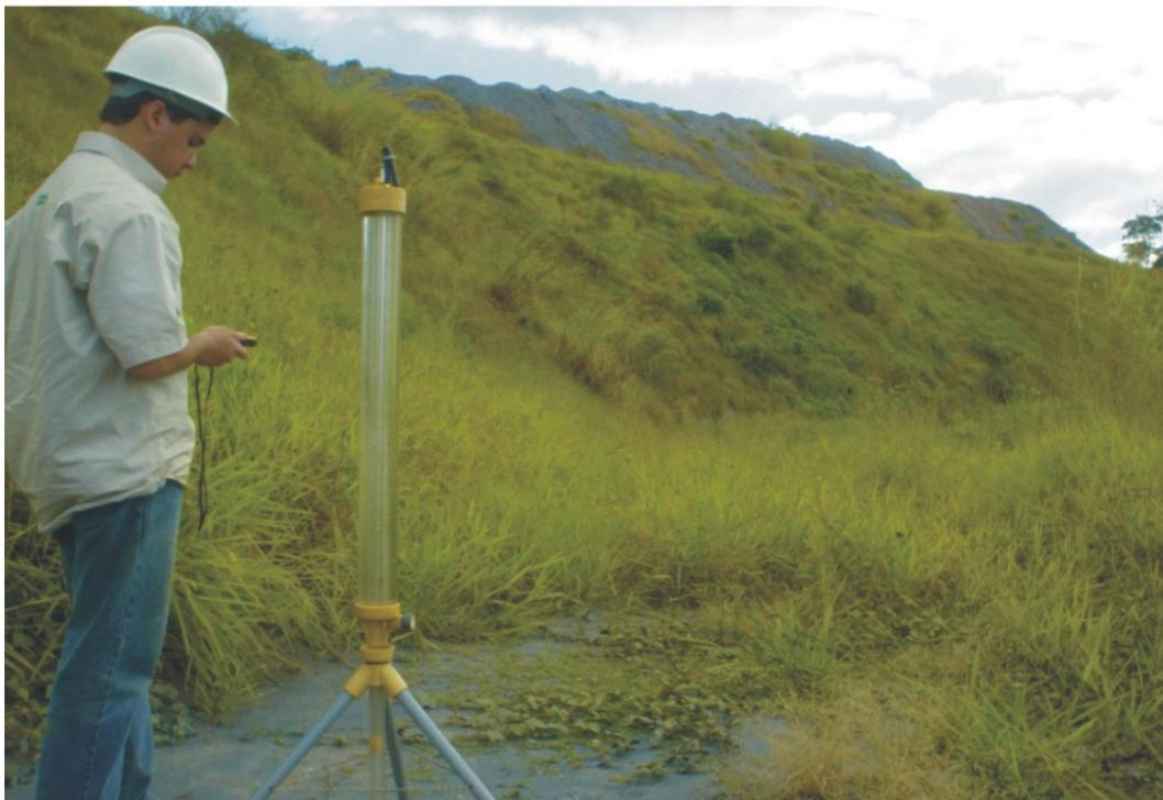
Figura 13 – Execução do ensaio EN-6a utilizando o permeâmetro de Guelph, realizado no 1º banco. Ao fundo, vista do 2º, 3º e 4º bancos da pilha de estéril PDE-05.
