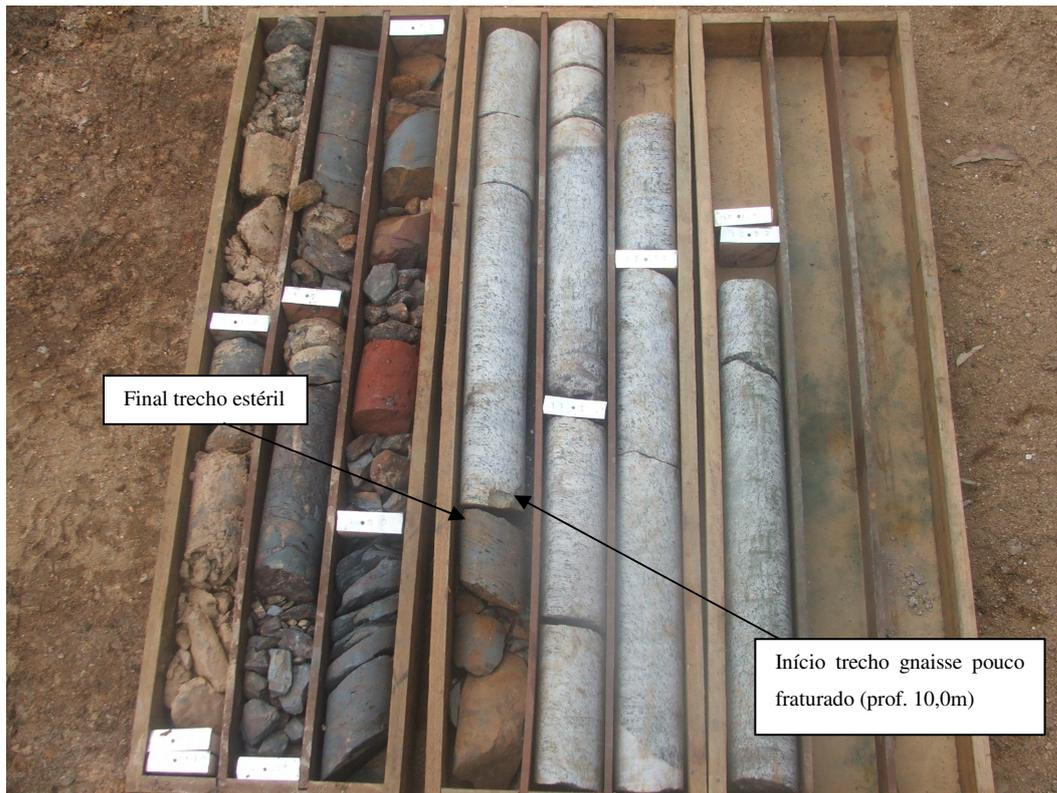
Figura 12 – Testemunho da sondagem rotativa NA-ANPE2-03 apresentando o início do gnaiss pouco fraturado a são a partir dos 10,0 m.
