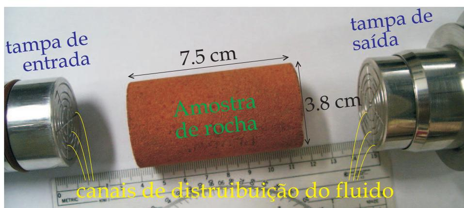
Figura 4.1: Fotografia do corpo de prova mostrando suas dimensões.
