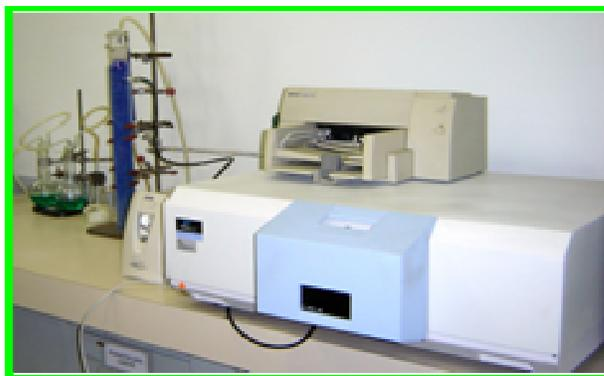
Figura 6 : Espectrofotômetro de luminescência Perkin-Elmer LS 55.
