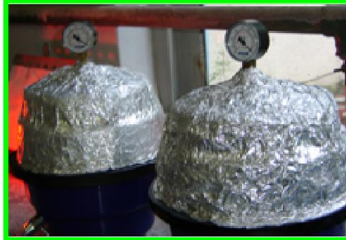
Figura 9: Sistema de secagem a vácuo para substratos de papel.
