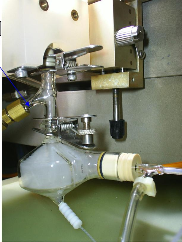
Figura 4. Esquema de montagem para introdução de oxigênio na vazão de argônio auxiliar
