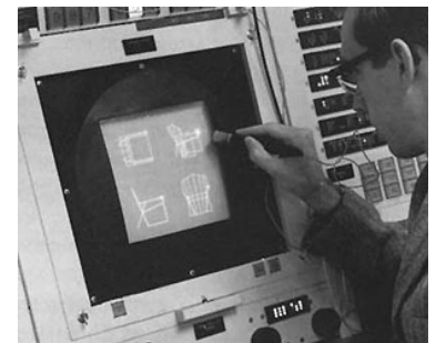
Figura 67 - Sketchpad , linguagem de programação precursora das em uso nos modernos CAD. Na imagem, um técnico utiliza uma caneta de luz para traçar vetores na tela de um TX-2 (MASA, 2005).
