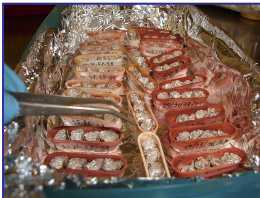
Figura 3.3. Cápsulas de prata acondicionadas em 'barcas' de porcelana para oxidação térmica a 375 °C.
