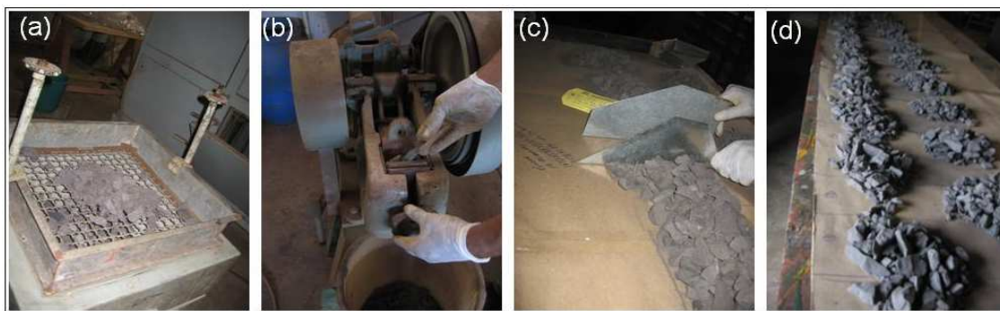
Figura 9. Preparação das amostras a) Peneiramento b) Britagem c) e d) formação de pilhas longitudinais.
