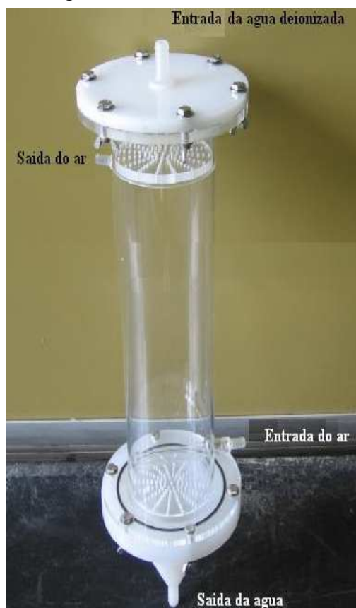
Figura 11. Coluna da unidade experimental, mostrando a entrada e saída da água e do ar.
