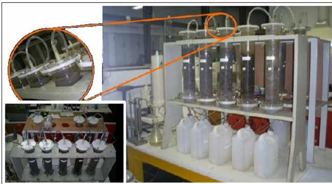
Figura 12. Montagem das colunas.
