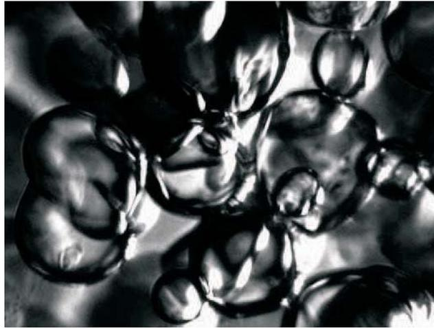
Figura 1.2: Fotografia de cristais de gelo em uma pasta de gelo (tamanho da fotografia  $1061 \mu\text{m} \times 762 \mu\text{m}$ ) [4].
