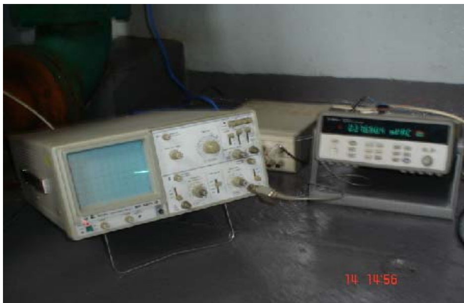
Figura 34 – Instrumentação para medição do sinal do acelerômetro.
