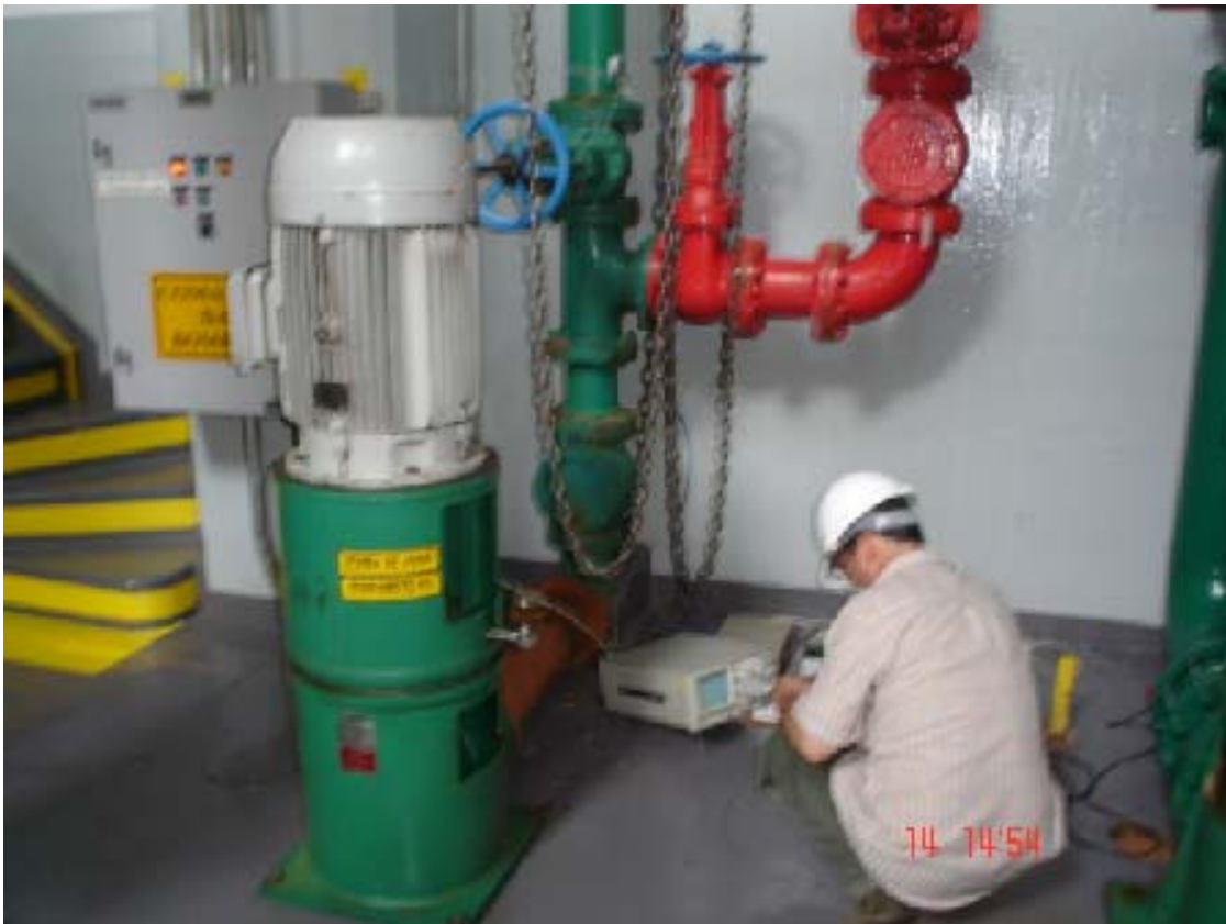
Figura 35 – Instrumentação para medição do sinal do acelerômetro.
