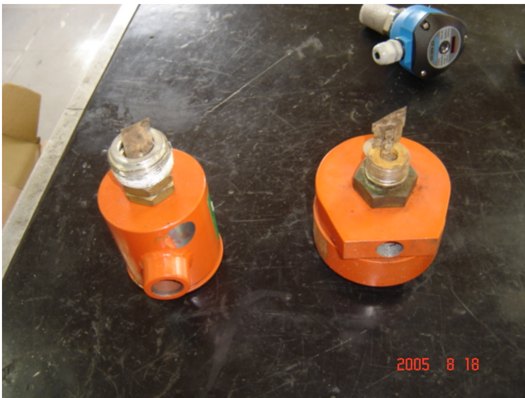
Figura 3 – Medidores Tipo Palheta – Danificados pelo desgaste provocado pelos sólidos em suspensão existentes na água
