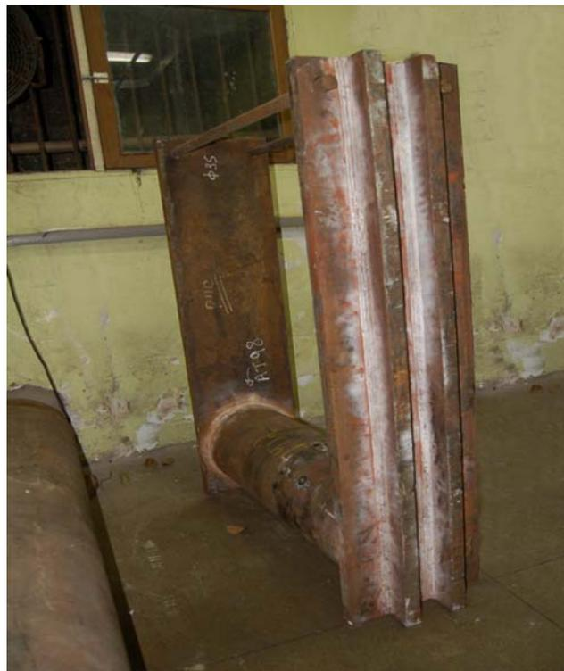
Figura B.1. Bancada para aplicação de pressão interna, flexão e esforço axial no tubo.
