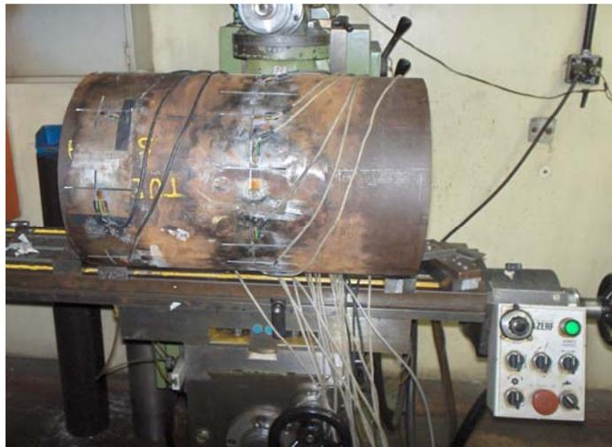
Figura 5.1. Fresadora com o tubo posicionado para cortes longitudinais.
