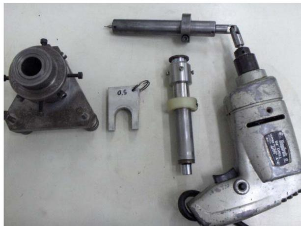
Figura. 5.9. Da esquerda para a direita: Guia de furação, blocos padrões em U, lupa e furadeira.
