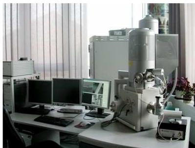
Figura 4.14: FEI Nova Nanosem 200 SEM do IFW-Dresden. Este microscópio trabalha em um modo de baixo vácuo.
