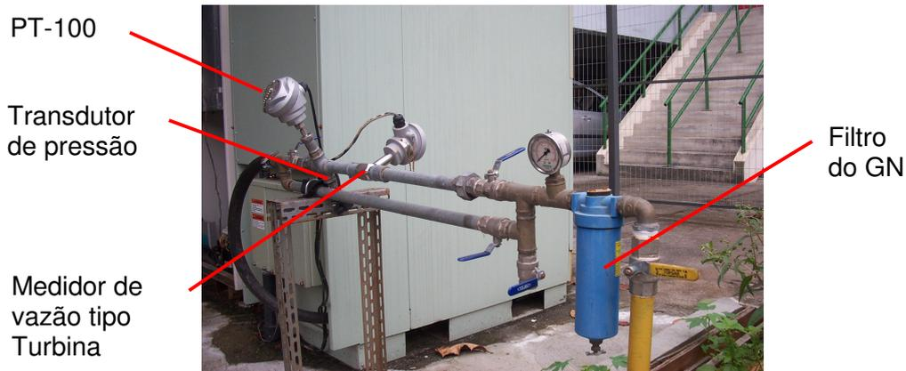
Figura 25 – Instrumentação – vazão, temperatura e pressão do gás natural
