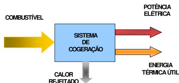
Figura 1 – Diagrama de um sistema de cogeração
