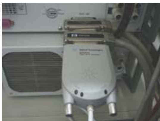
Fig 13 – Conexão ente a Interface USB/GPIB e cabos GPIB
