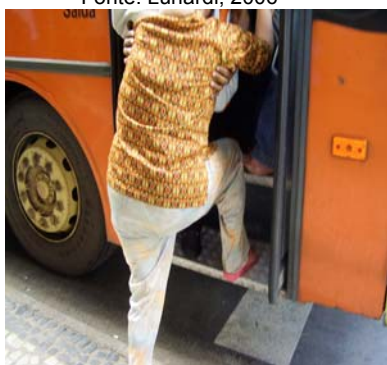
Figura 86 – Degrau de ônibus Altura excessiva do primeiro degrau para acesso ao ônibus.
