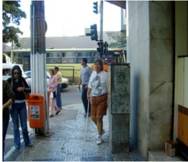
Figura 60 - * Mobiliário urbano obstruindo passagem
