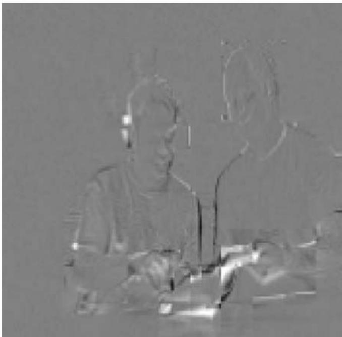
Figura 21- Resíduo (com compensação de movimento e tamanho de bloco 16x16)
