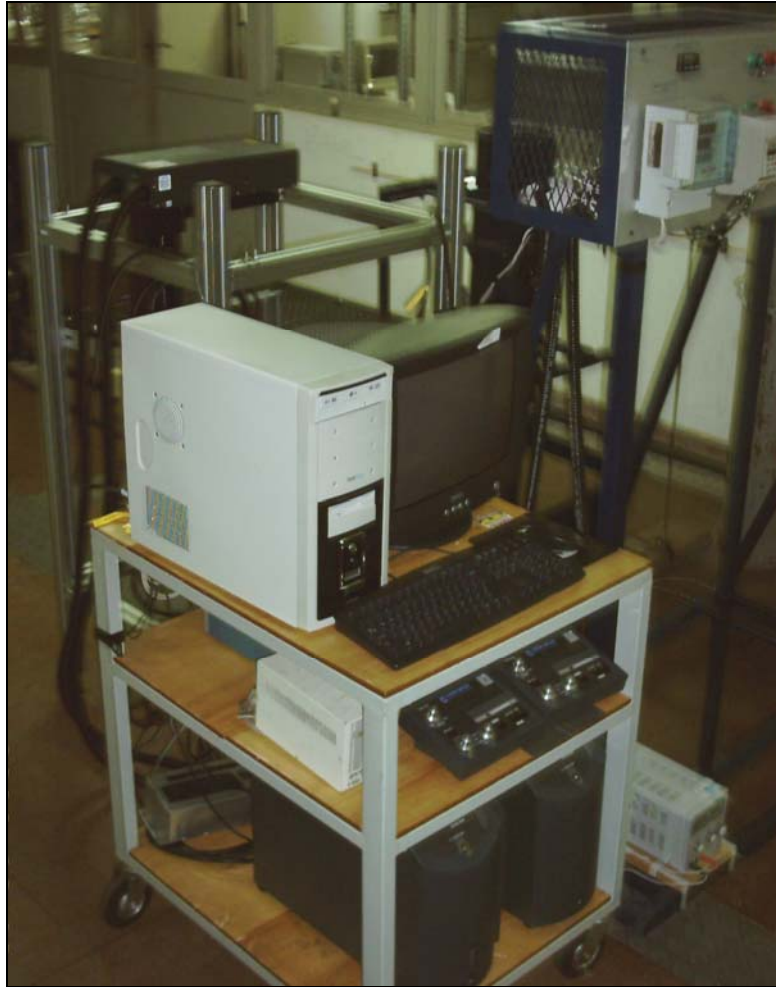
Figura 3.21 – Principais componentes do sistema PIV montado na instalação experimental.
