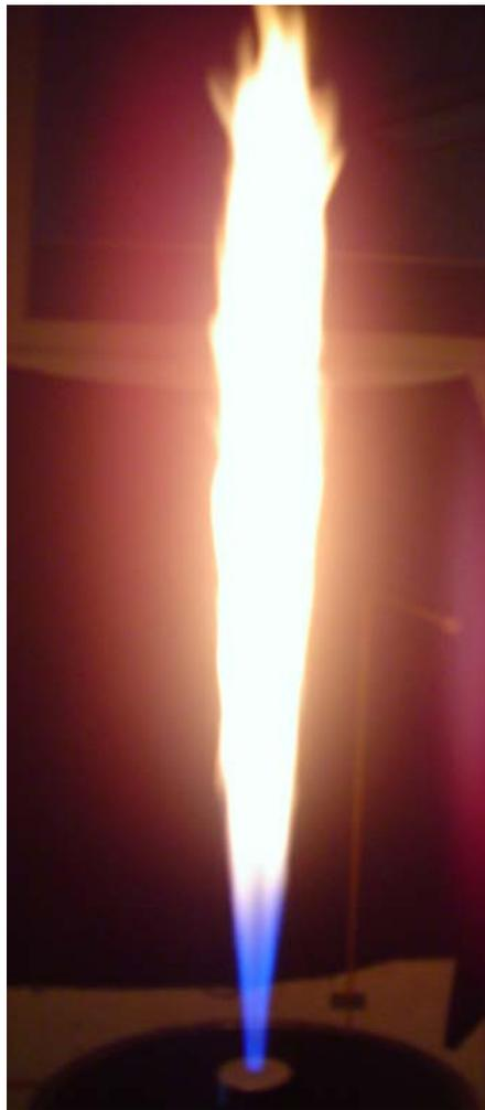
**Figura 1.1** – Fotografia do queimador tipo obstáculo operando em regime turbulento com velocidade média do jato central de GNV de 51 m/s ( $Re=7235$ ) e ar anular de 1,5 m/s.
