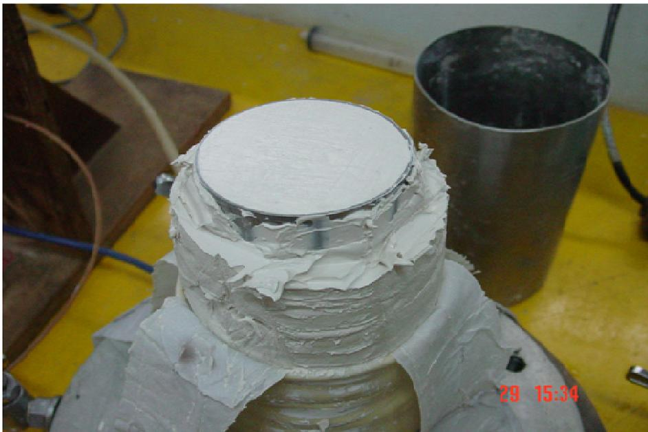
Figura 11 – Preparação do corpo de prova a partir de cravação do anel de aço inoxidável.
