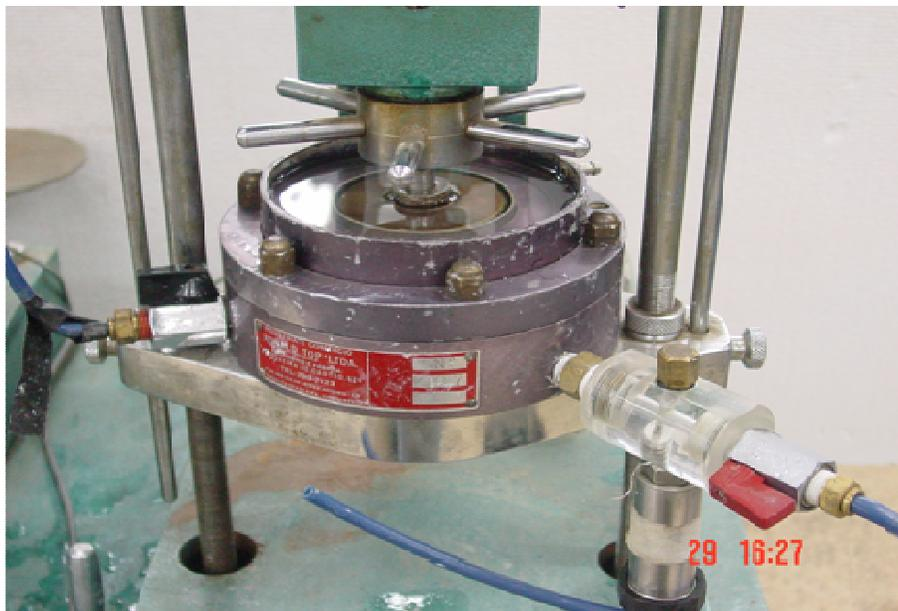
Figura 13 – Célula de ensaio de adensamento SICu com leitura de poropressão na base
