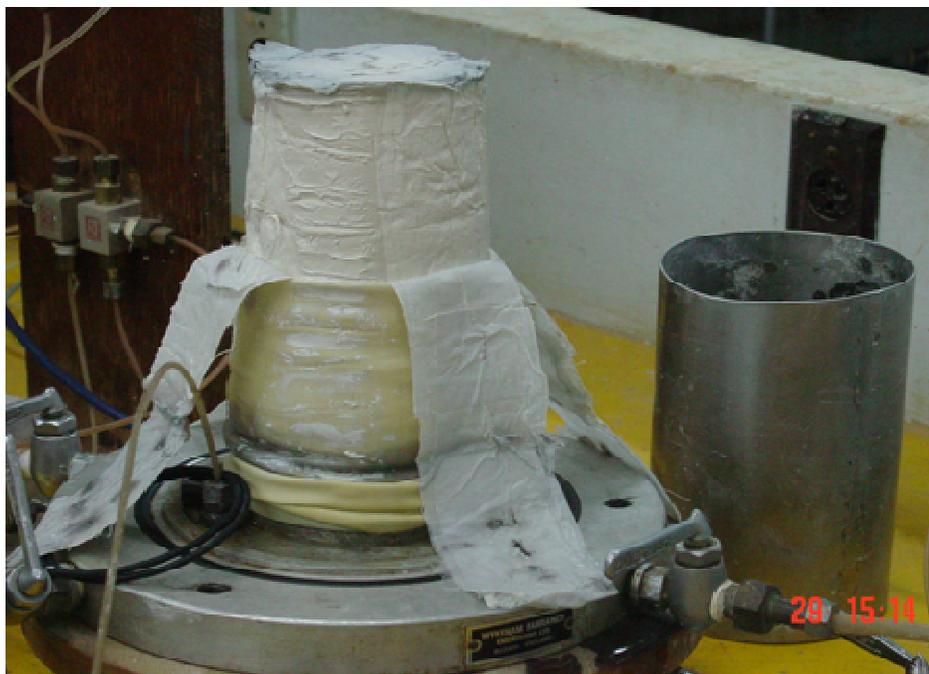
Figura 10 – Amostra da mistura caulim-bentonita após o adensamento hidrostático.
