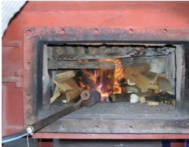
**Figura 27.** Foto do gaseificador GCC (queima de lenha para no início do processo de gaseificação)
