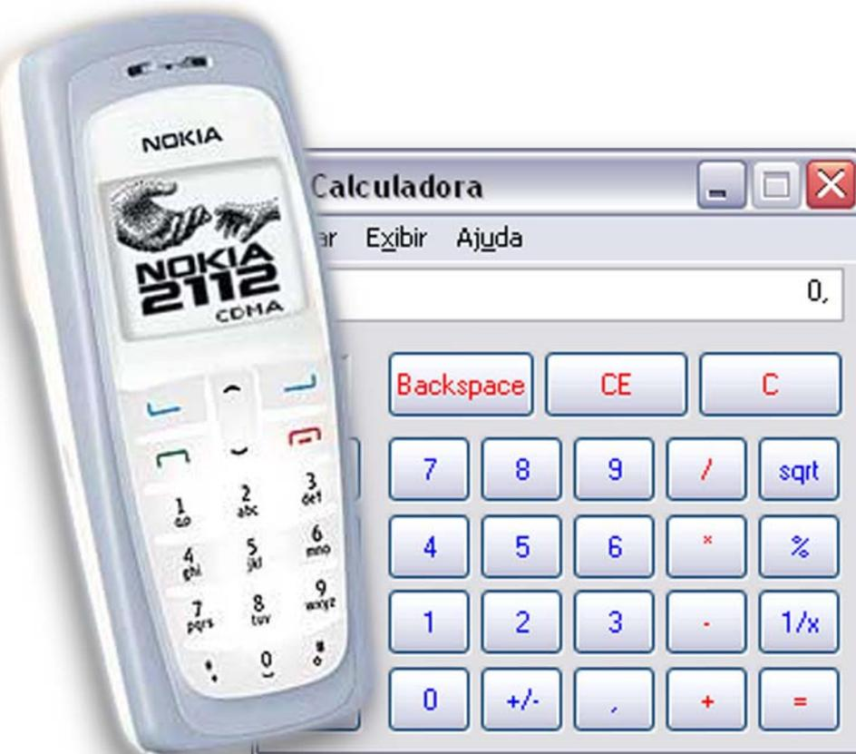
Figura 5: falta de padronização entre as teclas dispostas em um aparelho telefônico e em calculadoras.
