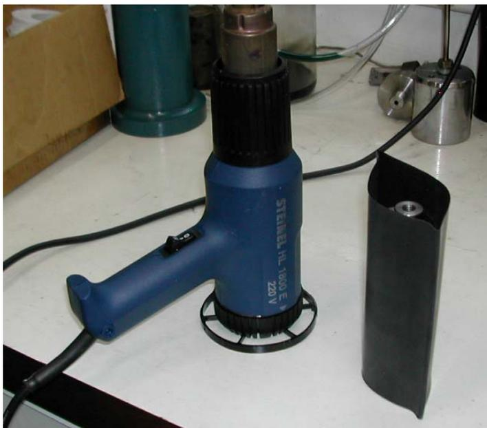
Figura 3.18 – Soprador térmico e corpo de prova envolvido pela membrana termo-retrátil.
