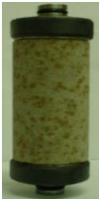
Figura 3.17 – Montagem do Corpo de prova. Os caps estão envolvidos com fita alta fusão.
