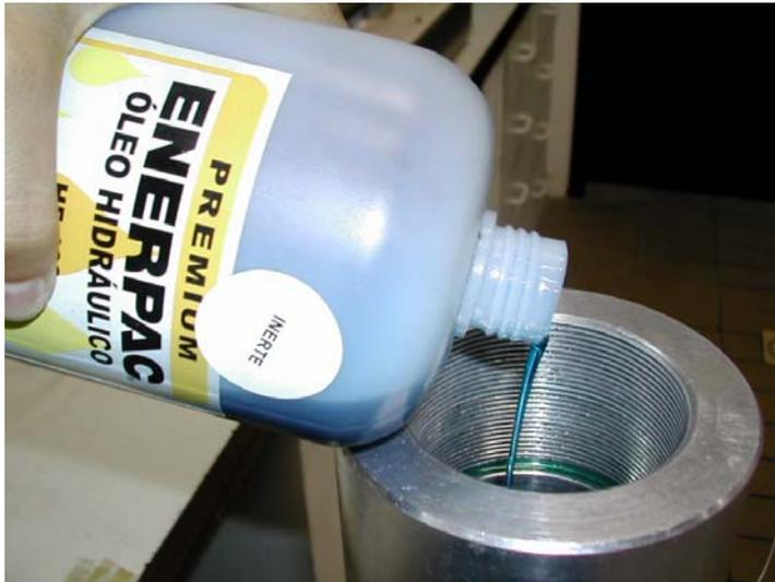
Figura 3.22 – Colocação do óleo na célula.
