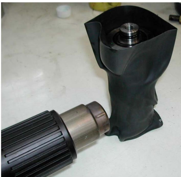
Figura 3.19 – Retração da membrana devido ao calor.
