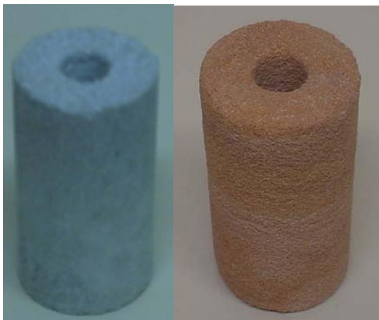
Figura 3.16 – Corpos de prova após a perfuração: á esquerda arenito sintético e á direita arenito Sergi.
