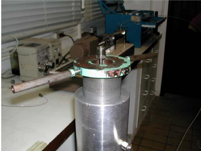
Figura 3.24 – Travamento do sistema com a tampa rosqueada.
