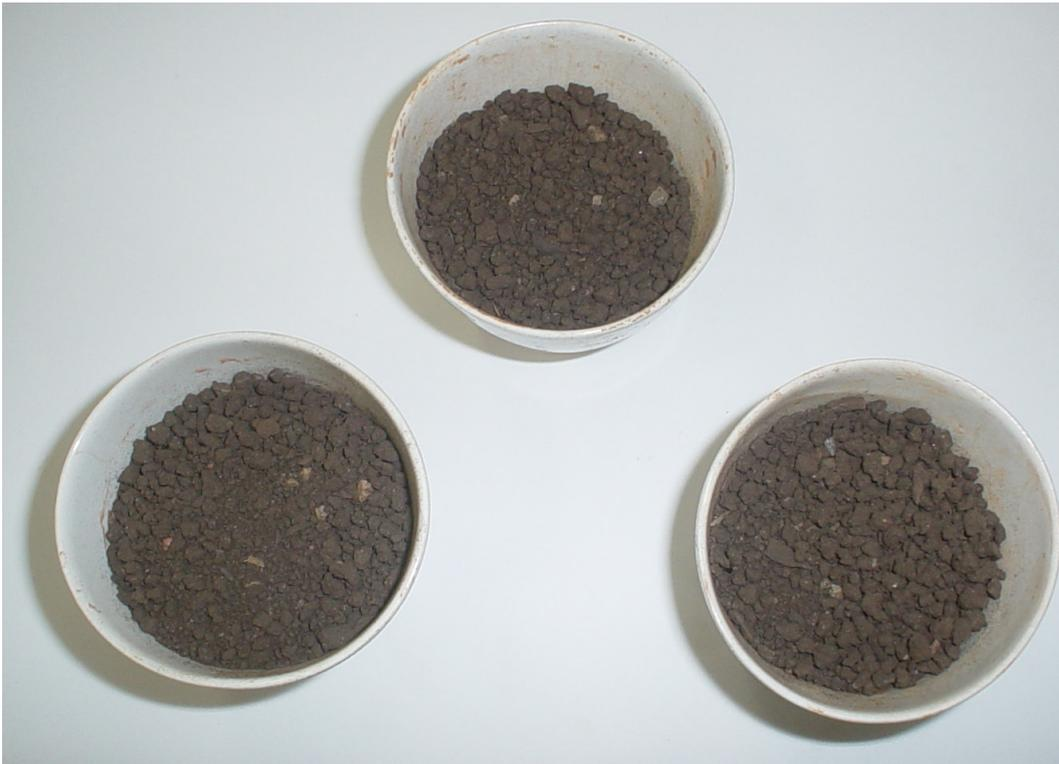
Figura 5.8-Recipientes com composto orgânico seco em estufa a 110°C antes de ser colocado na mufla.
