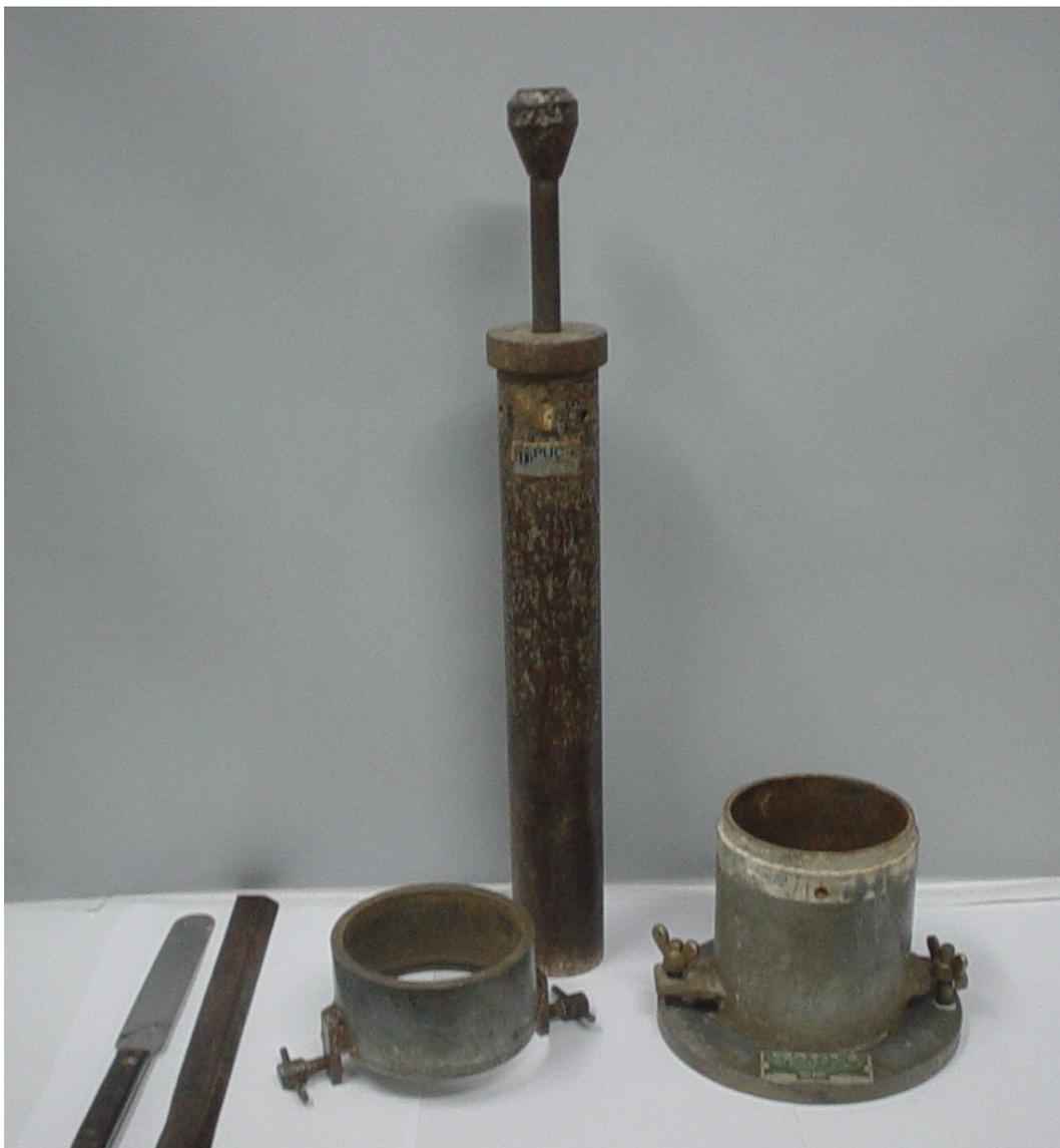
Figura 4.1-Instrumentos do ensaio Proctor Normal.
