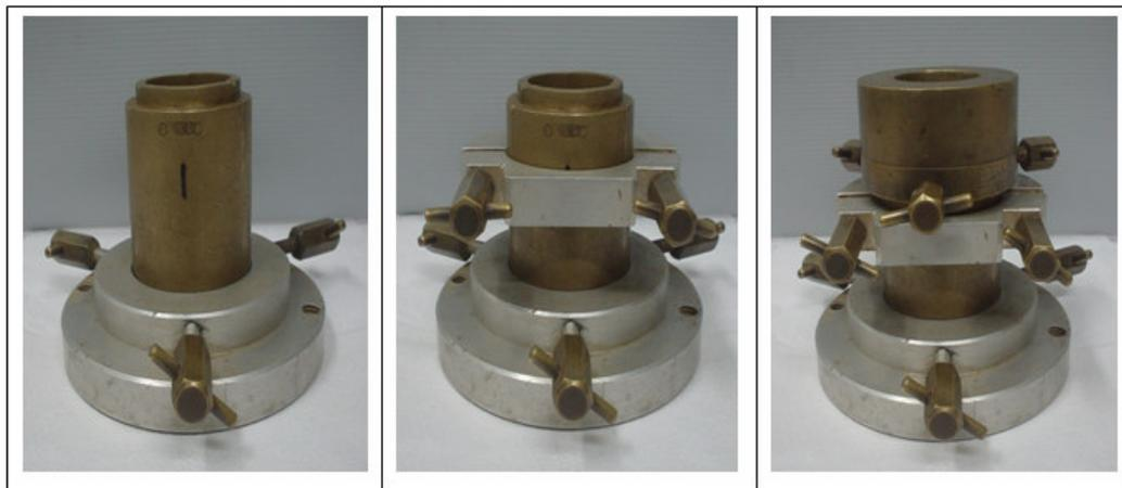
Figura 4.4-Molde cilíndrico tripartido e anéis de confinamento.
