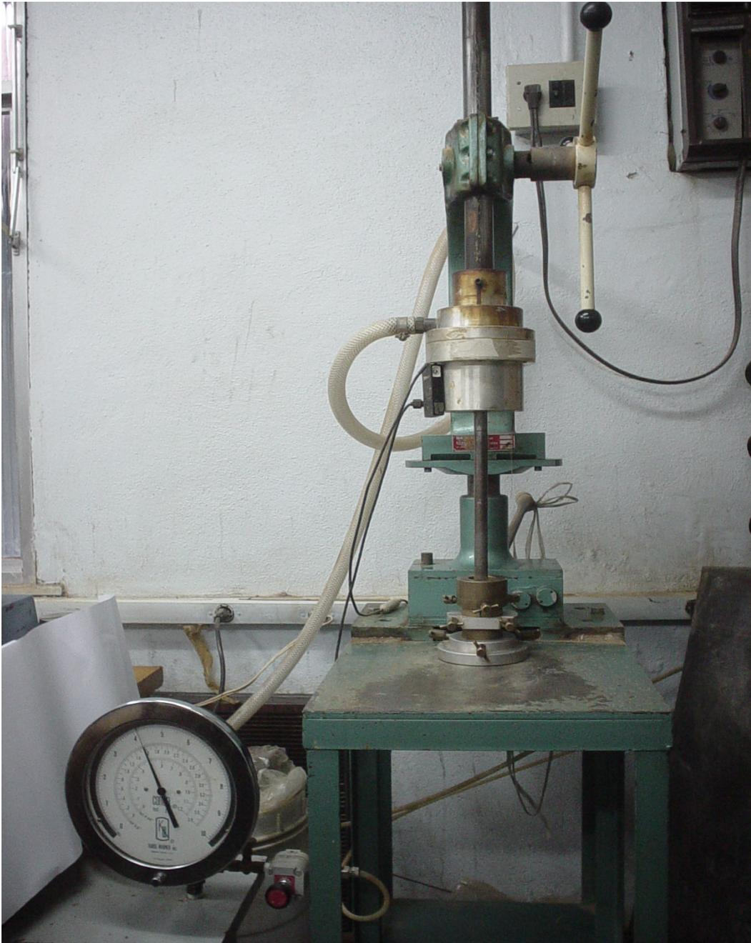
Figura 4.3-Compactador Pneumático.
