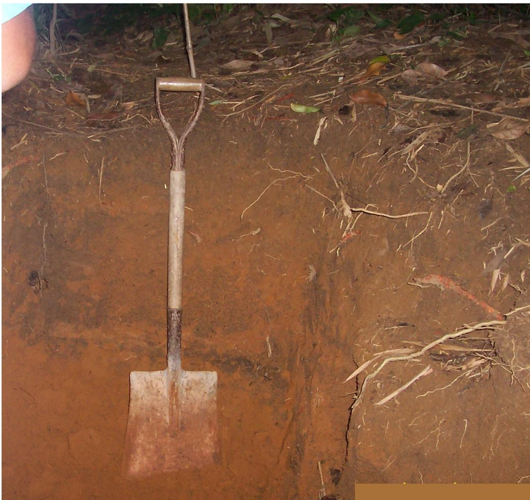
Figura 3.4-Profundidade da escavação para extrair a amostra deformada.
