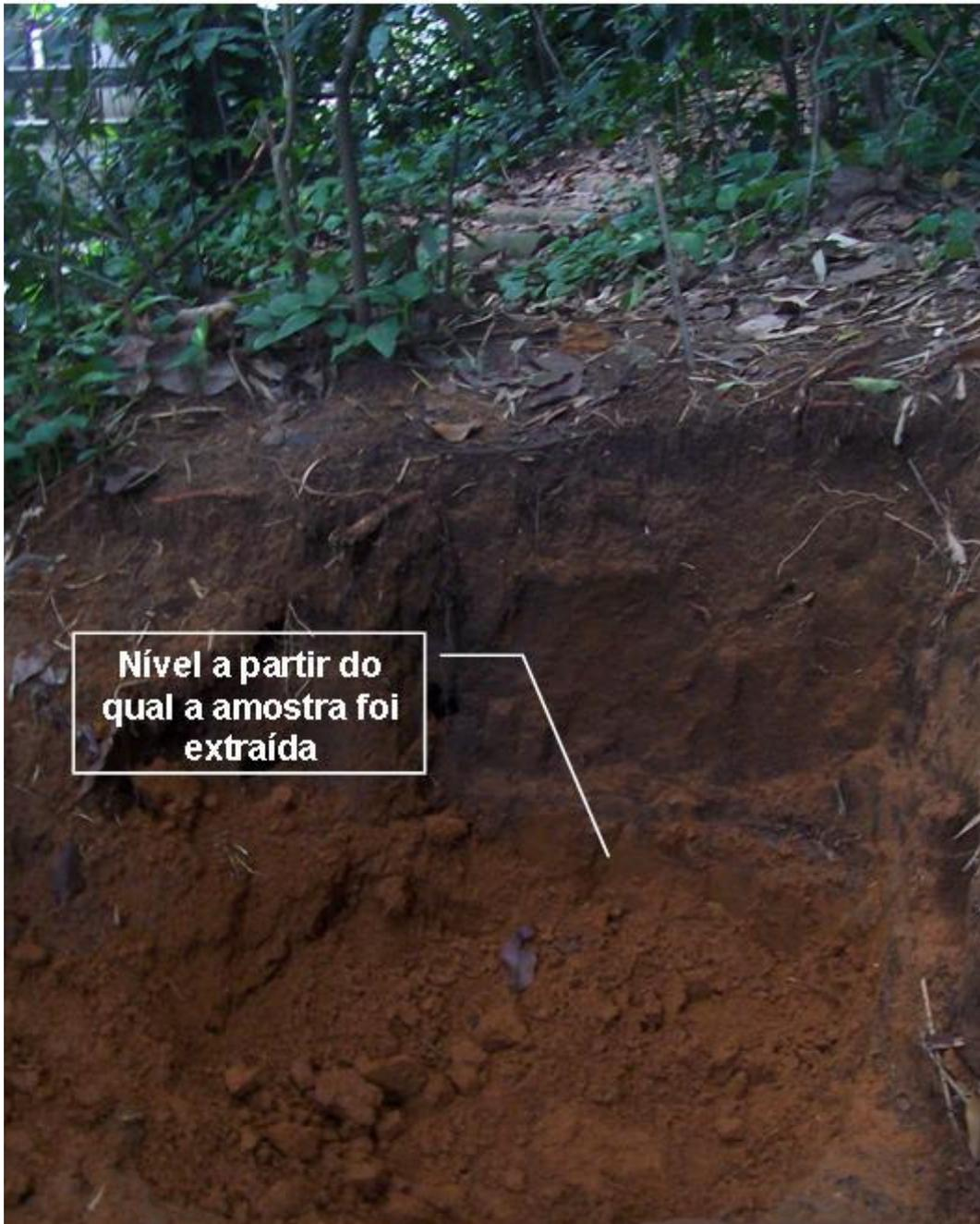
Figura 3.3-Retirada da amostra deformada no Campo Experimental II da PUC-Rio.
