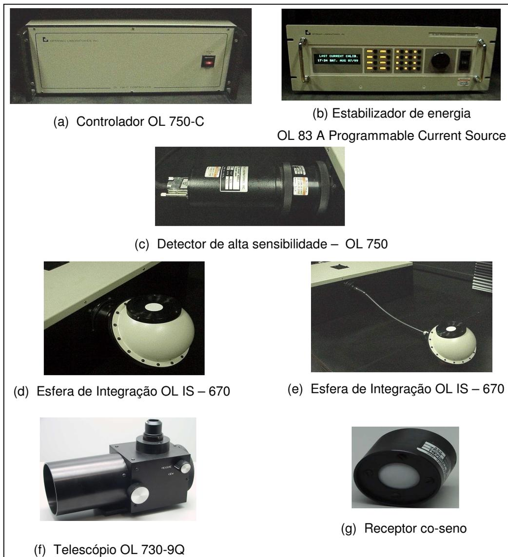
Figura 44. Elementos/acessórios básicos utilizados nas medições de irradiância
